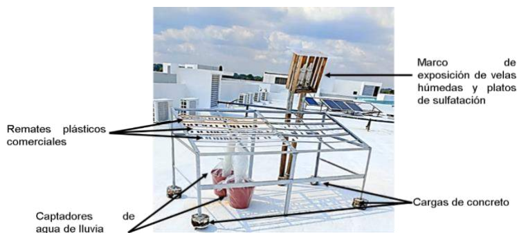
Figura 2. Rack de exposición de las probetas
